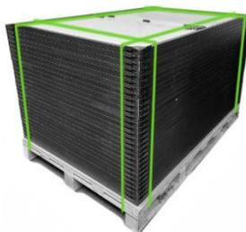
**Bei Verwendung von Schweißbändern:** Die Fläche, auf der die beiden Bandseiten miteinander verschweißt sind, darf nicht kleiner als 90% der Breite des Umreifungsbandes sein.
